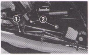
Fig. 35 (1) Muffler (2) Bolt
