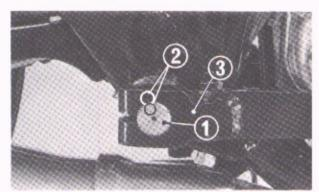
Fig. 22 (1) Pivot shaft
