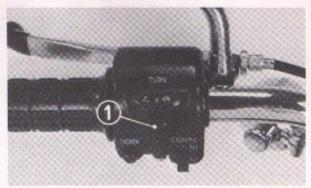
Fig. 46 (1) Horn switch
