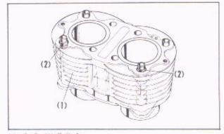
Fig. 2-3 (1) Cylinder (2) Cylinder stud bolt gasket
