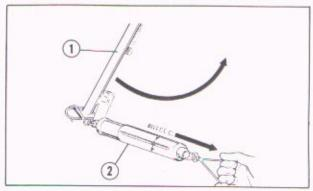
Fig. T-3 (1) Side stand bar (2) Spring Scale
