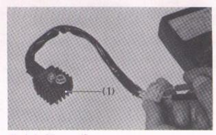
Fig. 6-5 Silicon rectifier
