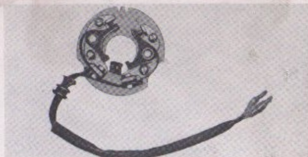
Fig. 6-9. Contact breaker
