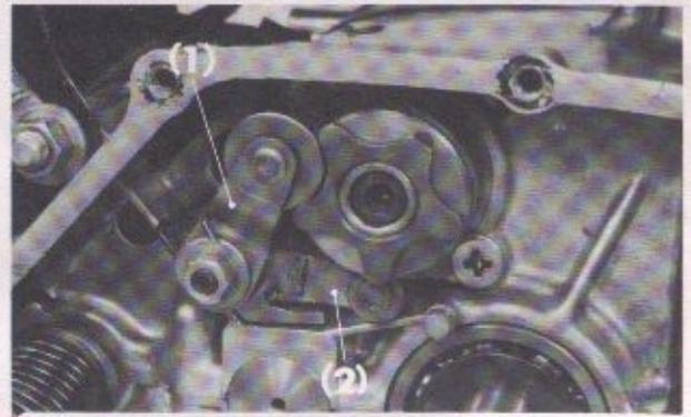
Fig. 3-38 (1) Gear shift drum stopper
