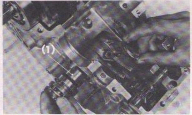
Fig. 3-42 (1) Gear shift drum
