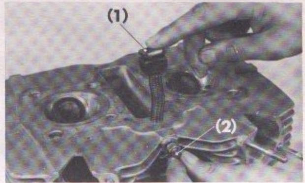
Fig. 3-18 (1) Tensioner push bar
