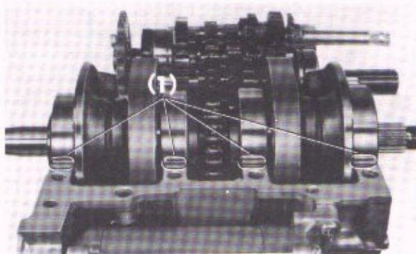
Fig. 3-63 (1) Aligning mark
